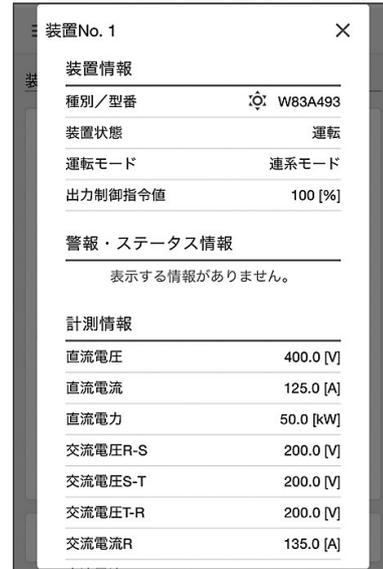
図8 装置状態・計測情報画面
