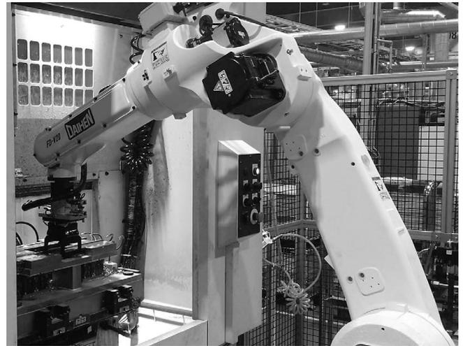
図4 ロボットと加工機の連携
