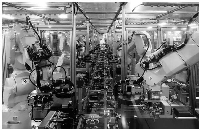
図6 ロボットを用いた部品挿入ライン
