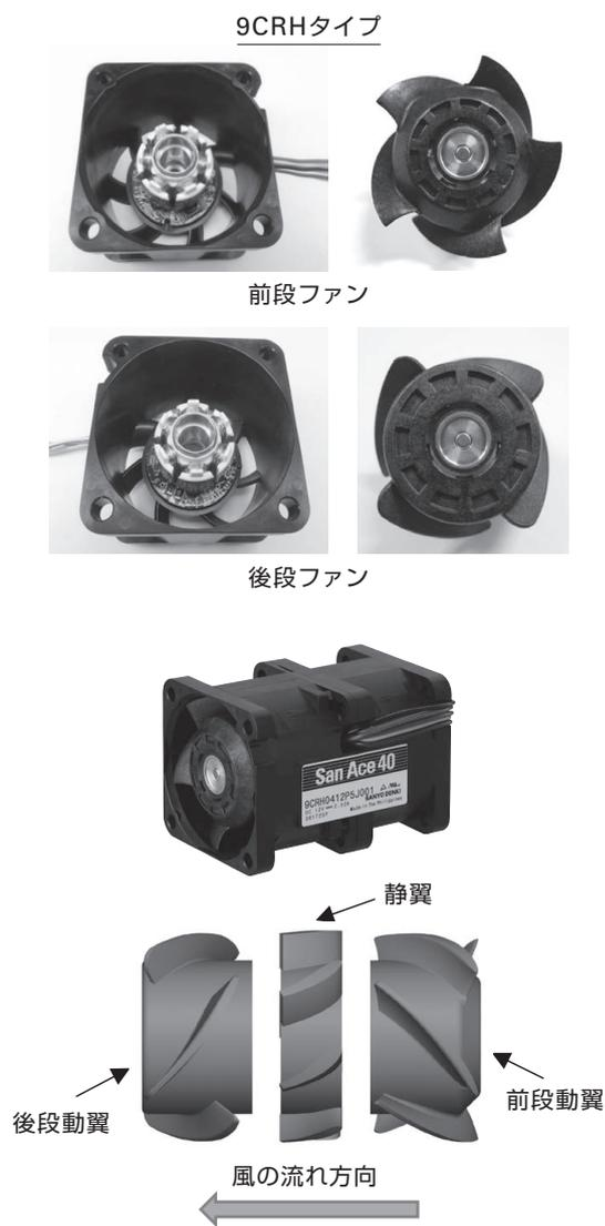
図9 □40×56mm厚二重反転ファンの構造例
