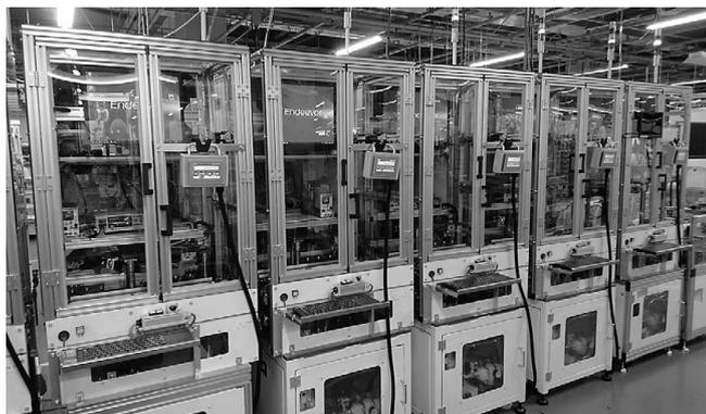
図5 モータ自動検査ライン
