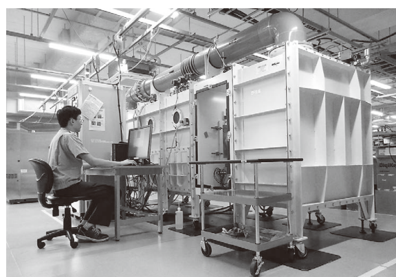
図2 風量－静圧特性測定用ダブルチャンバー測定装置
